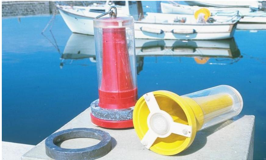
Photo 1 : Appareil intégrateur (« cloche Pelletier »), préleveur de plancton
