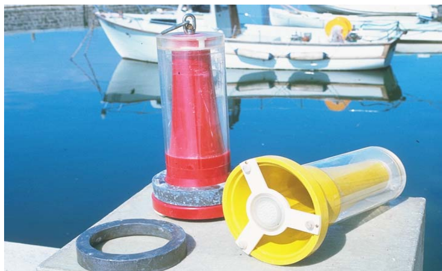
Photo 1 : Appareil intégrateur (« cloche Pelletier »), préleveur de plancton
